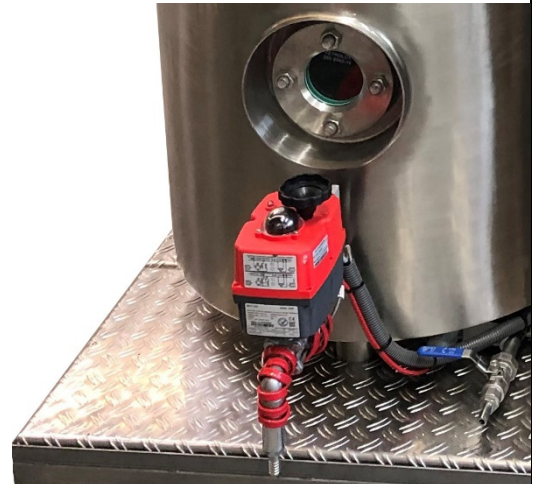
Beheizter Ausgang für Knochenfett an der Anlage. Leicht zugänglich und effektiv
