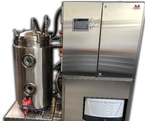
Knochenfett-Extraktionsanlage mit DCM-Rückgewinnungs- und Knochentrocknungsmodul. Entfettungskammer: 500mm AD x 900mm(H)
