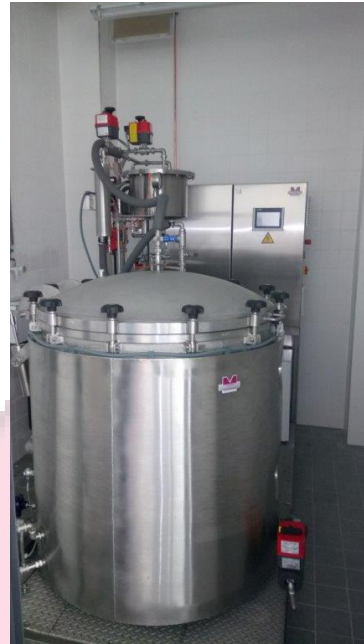
BEU-100 Knochenentfettungsanlage mit DCM-Rückgewinnungs- und Knochentrocknungsmodul. Entfettungskammer: 1000mm AD x 900mm(H)
