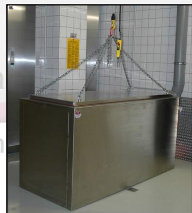
MA-1343 in geschlossenem Zustand (Abluftleitung führt nach oben zur Decke)
