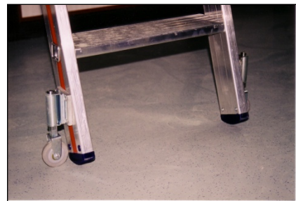
Feststell-Mechanismus der Sicherheitsleiter
