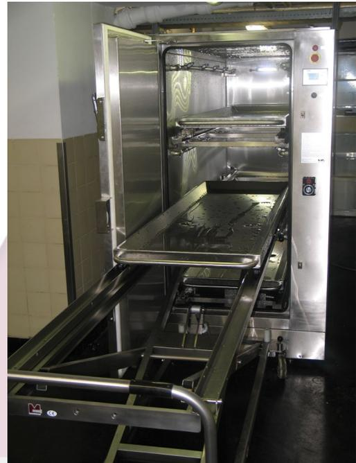
Be- / Entladen der SprayCon-Anlage ohne ein manuelles anheben der Körperspender
