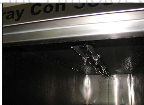
Sprühdüsen der SprayCon-Anlage
