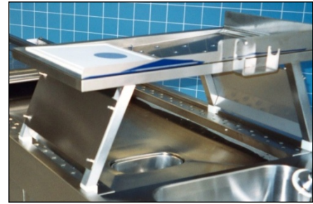
Aufsatz-Organisch mit konkaver Zuschneide- und Lagerfläche. Mittiger Flüssigkeitsablauf. Abnehmbare Spritzbleche seitlich. Zuschneide-Platte aus Corian mit schwarzem Makropunkt
