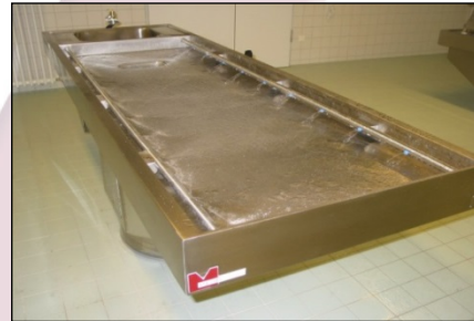
Seziertisch mit Randabsaugung und Flächenspülung. Steuerung über Ventil
