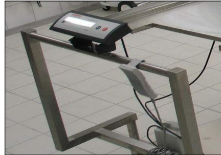
MA-2010 mit integrierter Digitalwaage (bis 300kg)
