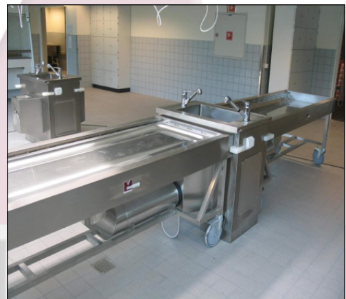
Studenten-Präpariertische mit Transfer-Arbeitsfläche und Absaugung nach unten (Beispiel: Anatomie Trondheim / Norwegen)
