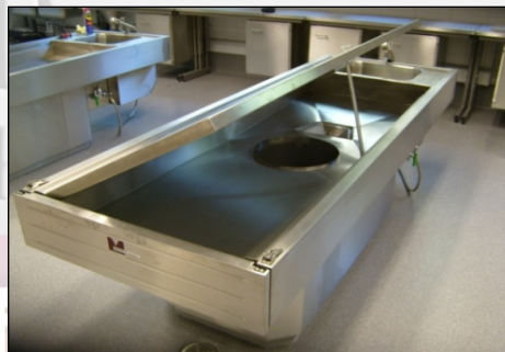
Beispiel einer sog. „Dom“-Absaugung, die wir als Sonderausführung nur einmal hergestellt haben. Der Boden ist nicht glatt und das Abluftrohr geht direkt in das Abluft-System. Abfall kann ungehindert in das Abluftsystem gelangen!
