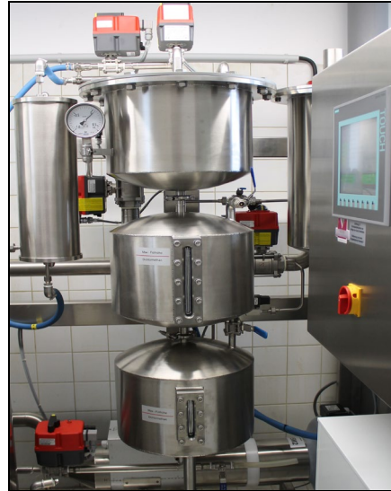
Dichlormethan-Rückgewinnungsanlage mit Kondensator und Vorratsbehälter
