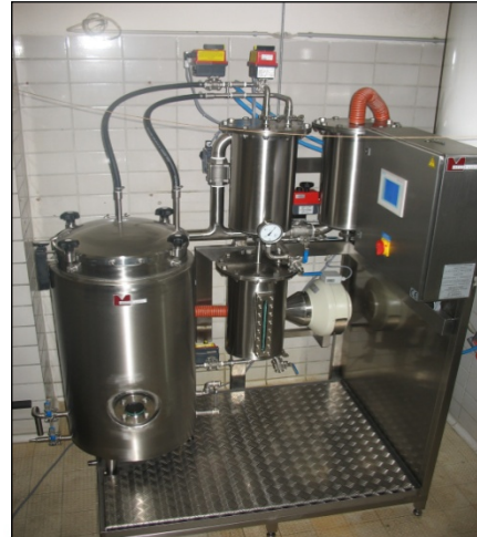
Knochenfett-Extraktionsanlage mit DCM-Rückgewinnungs- und Knochentrocknungsmodul. Entfettungskammer: 500mm AD x 900mm(H)
