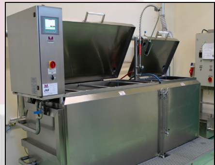
MA-1366 mit geöffnetem Deckel und Auftrittspodest
